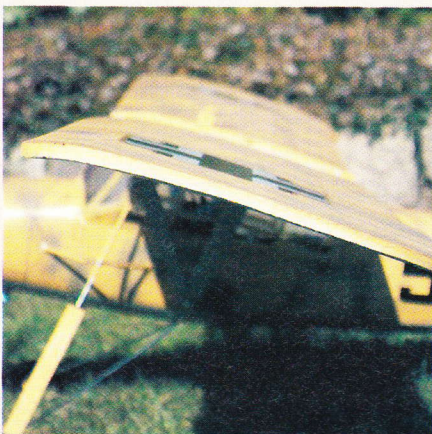
Fig. 4 Vingerne var lavet af krummede plader uden afrunding af for- og bagkant
