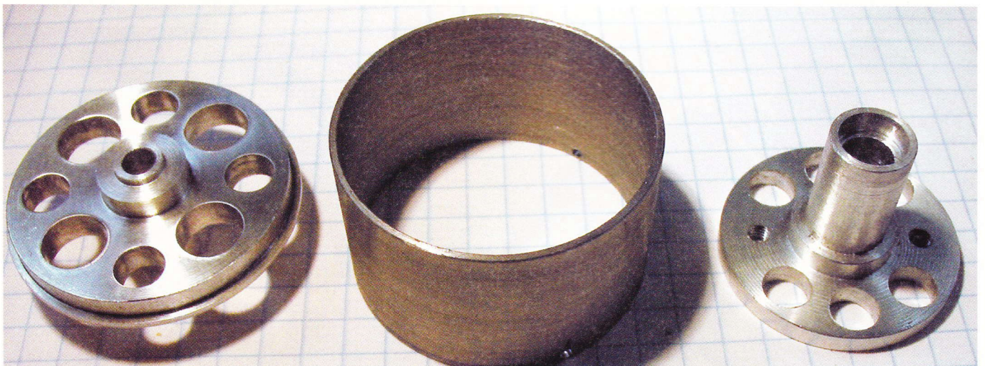
Herunder: De tre drejedele: fra venstre: Rotorholder, magnetholder og lejeholder.
