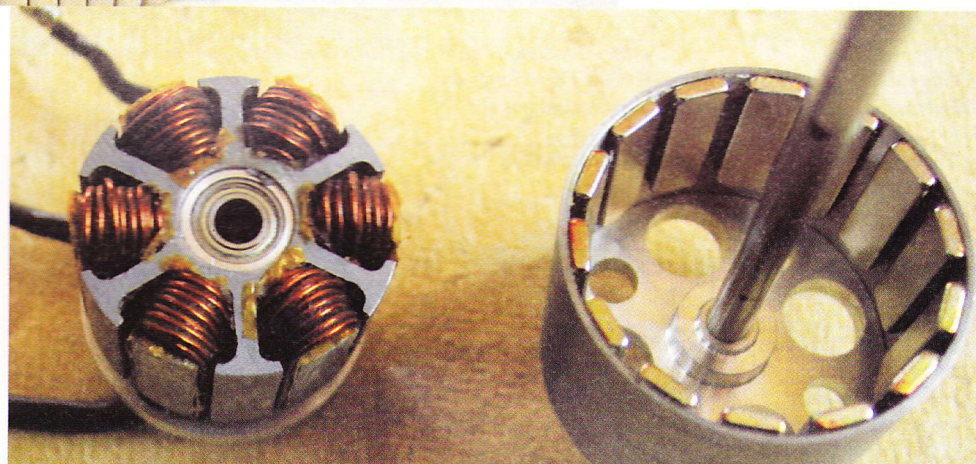
Tv: Magneter i størrelse 2mm x 6mm x 25mm alle magneter der benyttes i LKR-motorer er Neodym magneter.
