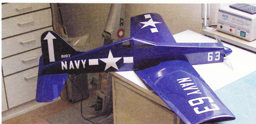
fig. 14 Beklæd og monter motor og radioudstyr, så modellen kommer i balance uden akku, og juster diverse udslag som angivet på tegningen.
