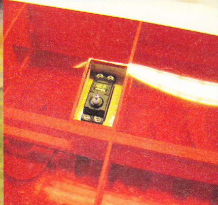
Servobrønden i den ene vinge. Læg mærke til det flotte håndværk der er udført fra fabrikken.
