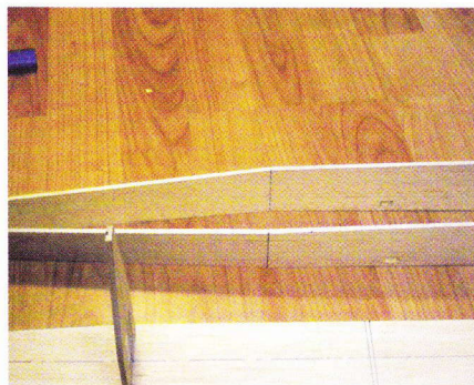
fig. 3 Udskær kropssiderne. Tegn en lodret streg på ydersiden langs bagkanten af K-4. Rids langs strengen og "knæk" forsigtigt pladerne over en bordkant.
