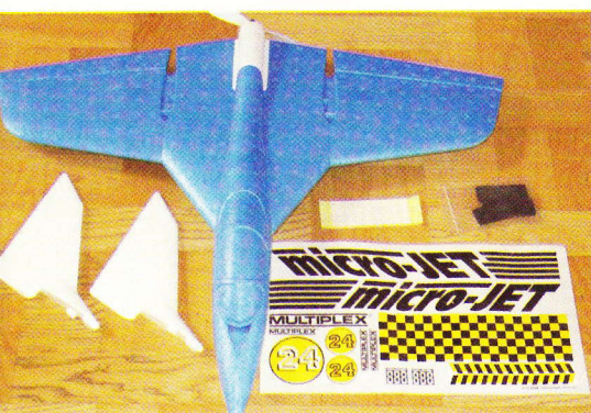
TV: Disse ting er med i kassen med Micro-Jet Her: Finnerne kan ikke sættes forkert på Th: De smarte kardandimser
