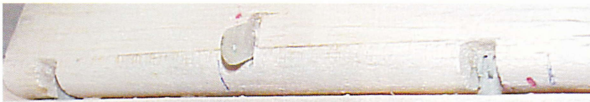
Højderors detalje, hvor man tydelig kan se kraftige robart hængsler og det nye glasfiber horn lavet af et stykke printplade.
