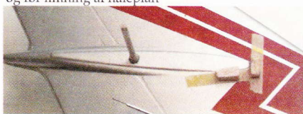
Ændret krængerorsservo og før limning af haleplan
