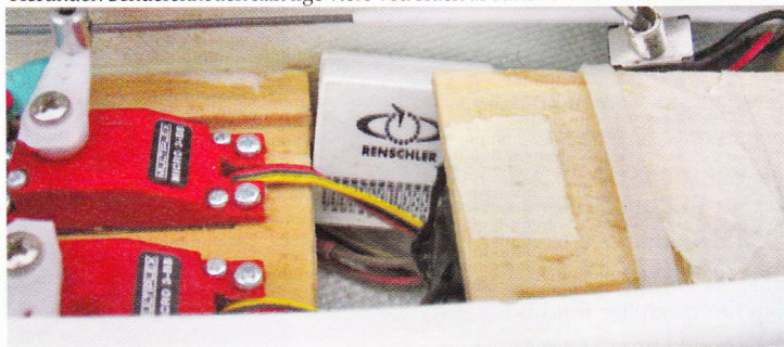
Herunder: Senderenheden kan lige være ved siden af batteribakken i en Elektromaster
