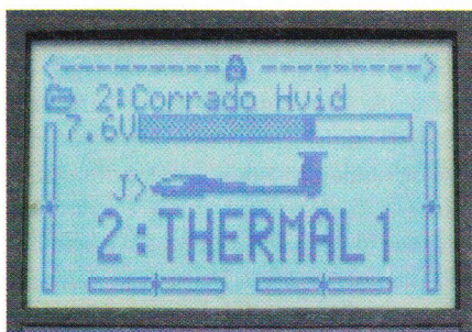
Nærbillede af skærmen mens der flyves i flyvefasen "Termik" med en svæver
