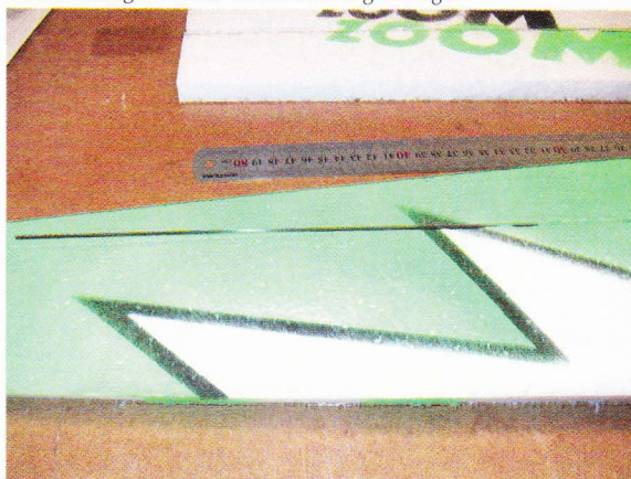
Kulfiberstang indsættes til forstærkning af vingen
