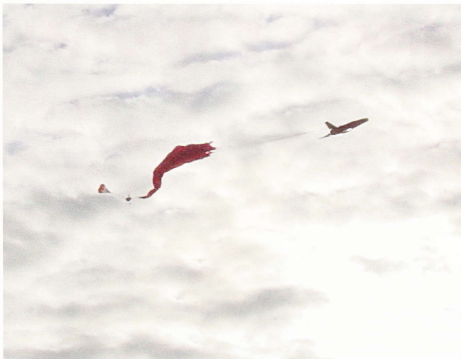
Dronens faldskærm udløses over sportspladsen og sikrer en skånsom landing af den dyre drone
