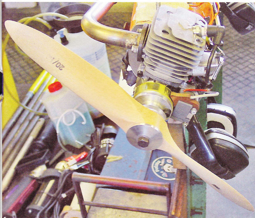
Motorinstallation i Dolpine dronen
