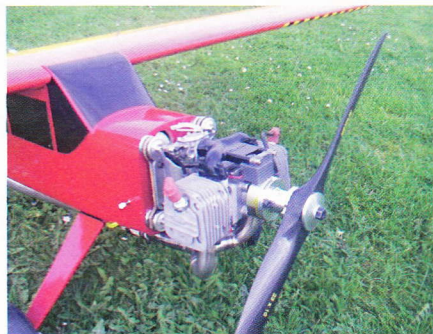
Kenneth Petersens Butler udstyret med Zenoah ZG80 med en enkelt resonansrør.
