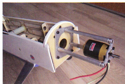
Motor og fundament monteret
