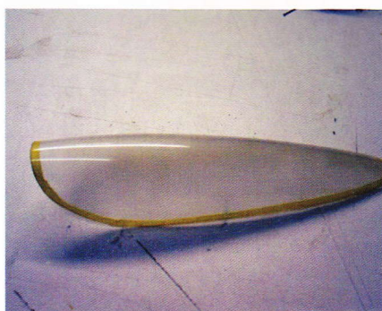
Canopyet er matslebet, og afrenset for fedtfingre og tape er påsat i kanten, så det kan....
