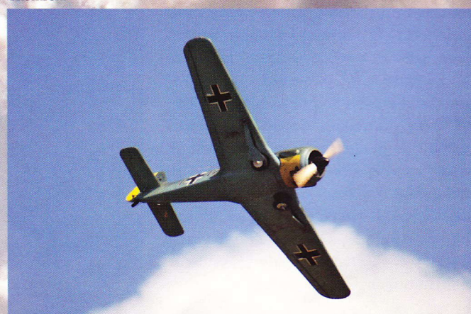
Pilot Kasper Holger, Focke Wulff (FW 190) på 15 kg. udstyret med en King 90cm3 motor, spændvidde: STOR. Fotograferet ved skalatræf i Filskov 7. maj 2005 af Lars Thomsen.
