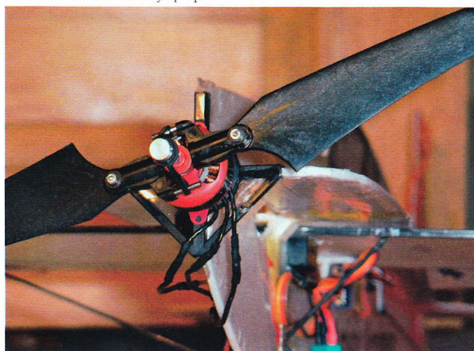
Nærbillede af propellen hvor styring og montering tydeligt kan ses
