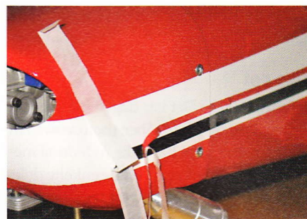
Til dekoration af cowl, er der langt stafferingstape med. Rigtig god ide, da man så er sikker på at få linjerne til at passe sammen med kroppen.
