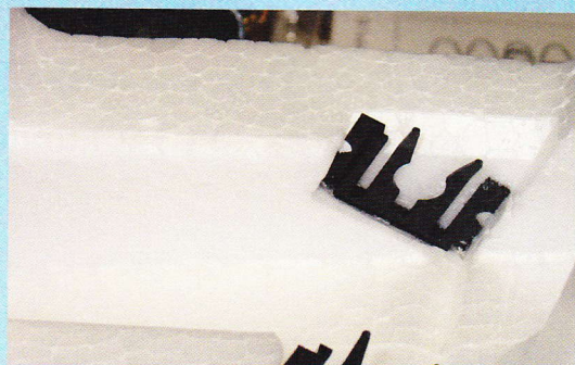
Låseclips ved canopyet. Foto PNM
