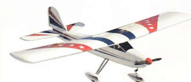
Air Trainer 2 (158 cm), ARF monteret med 4 servo og Magnum XL-46S (2-takt)
