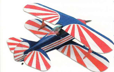
Air Trainer 2 (158 cm), ARF monteret med 4 servo og Magnum XL-46S (2-takt)
