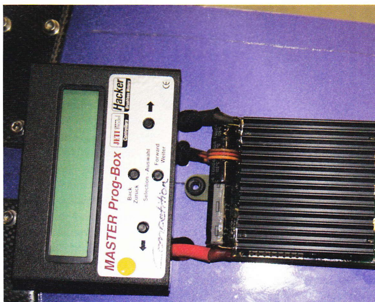
Hacker regulatoren monteret i Oxalys'en. Den ses her sammen med programmeringsboksen, hvor man bl.a. kan justere timingen og ikke mindst bremseeffekten.
