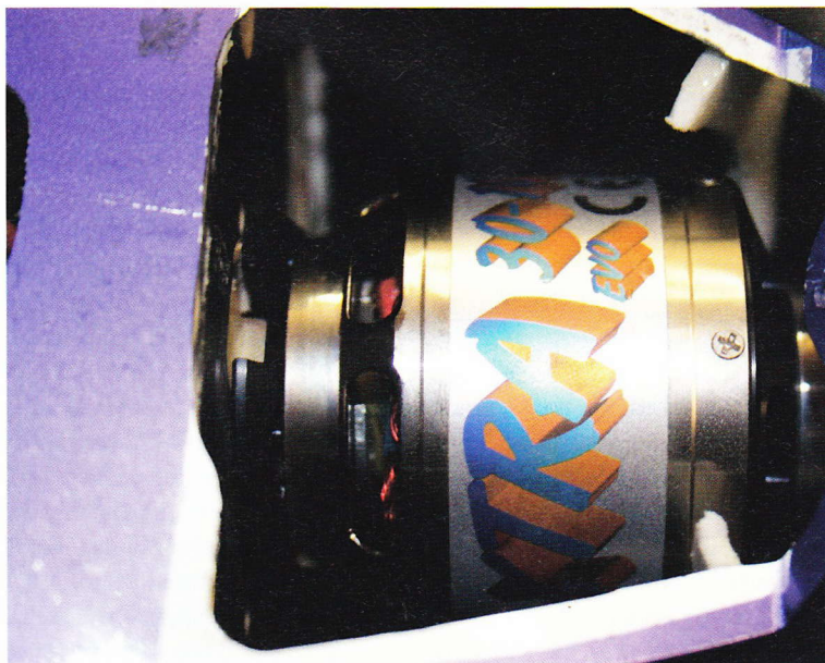
Plettenberg motor og Schulze regulator monteret i Oxalys.
