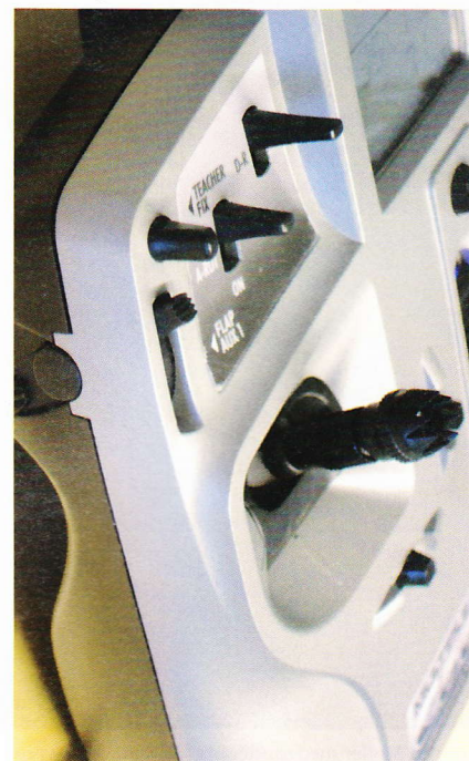
Skydeknappen til den femte og sjette kanal kan betjenes med pegefingeren, uden man tager tommele af pinden - smart!
