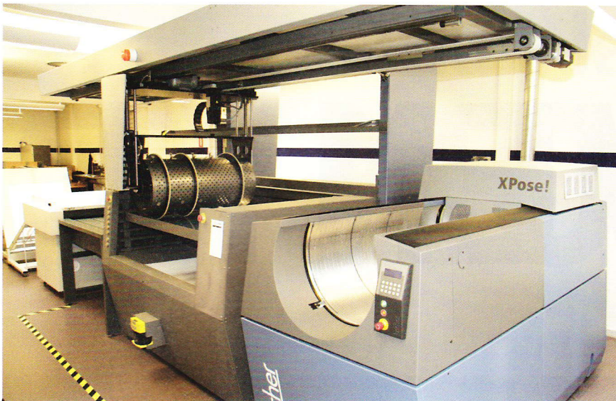
I den runde hulning skal aluminiums pladen ligge og laser hovedet roterer så inden i.
