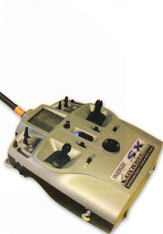
Skydeknappen til den femte og sjette kanal kan betjenes med pegefingeren, uden man tager tommele af pinden - smart!
