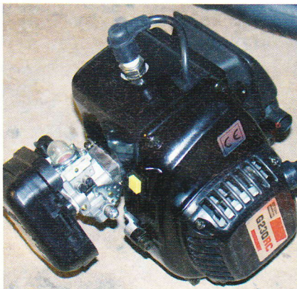
G230 motorens Walbro karburator og luftfilter til venstre og mod højre ses trækstart og det noget store blæsehus.
