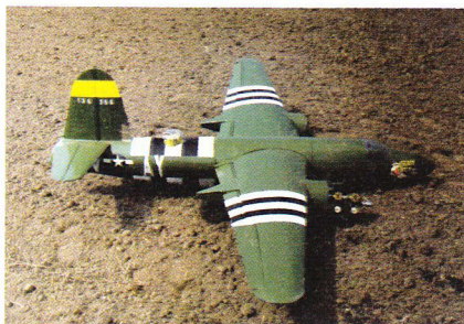
Og dette var resultatet efter flere måneders diskussion og reparation. En nødlanding ude i pløjemarken, bemærk det ene hovedhjul er bøjet helt tilbage ved nødlanding og venstremotor er revet af.
