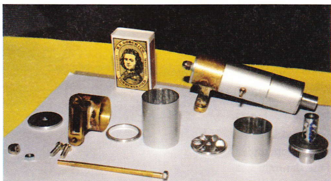
Dette billede viser, hvordan lydpotterne er opbygget, det hele er konstrueret og drejet ud af Alex Thomsen.
