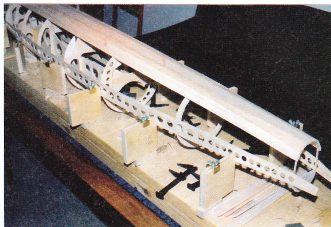
Kroppen er ved at blive beklædt med balsa, som er skåret i strimler.
