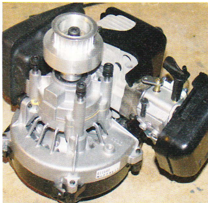
Zenoah G230RC motorens store blæshjul er effektivt, men det vejer meget.
