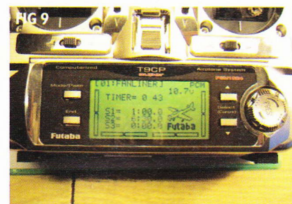
FIG 9 S1 er højstrømtimer og er sat til 1minut. Er aktiv mellem 90% og 100% gas. S2 er strømtimer og startes når gassen er over 5%. Du glemmer ikke at starte tidtagningen og får et bedre billede af dit strømforbrug i luften samtidig med at du modtager alarmer.
