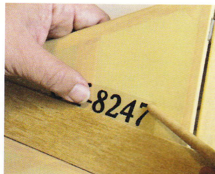
Bogstaverne trykkes fast, inden placeringsfilmen trækkes bort. Og så sidder de der – specielt på en glat overflade som Oracover. Her er det Solartex, og halefinnen fik derfor en gang Clearcoat for at fæstne bogstaverne.
