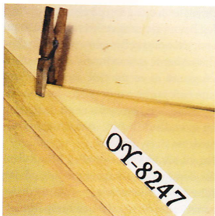
Jeg brugte et afstandsbræt til at få placeret registreringer helt lige på halefinnen.
