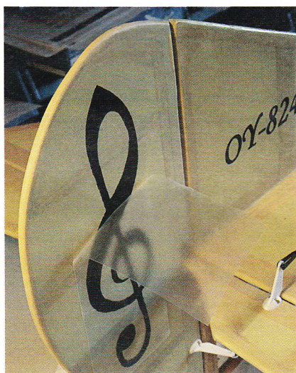
G-nøglen er placeret korrekt, og den selvklæbende placeringsfilm trækkes af.
