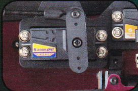
Ekstra stærk kullagret styreservo (med metaldrev, 9,8 kg!!).
