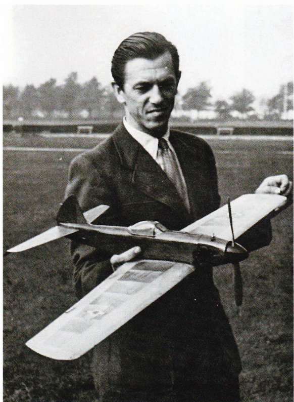
Peter Christiansen fra Helsingør satte 16. oktober 1949 danmarksrekord med denne kunstflyvningsmodel i klasse F2. Hastigheden var 87 km/t og modellen var udstyret med en ny engelsk dieselmotor Amco på 3,5 kubikcentimeter.
