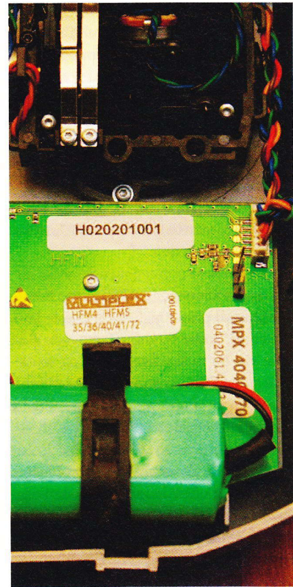
Sådan ser det ud, når sendermodulet er taget ud – der er stik i begge ender af modulet
