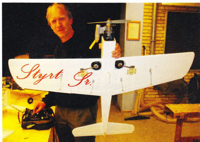
Jan S. Viser det optrækkelige understel på hans kobra, bemærk også flaps
