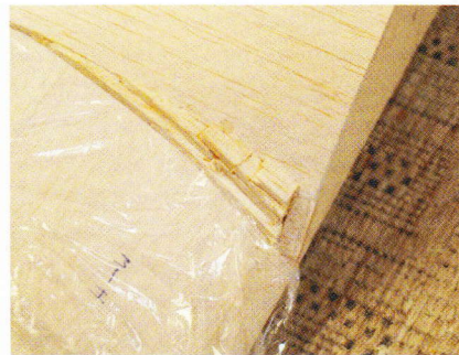
Opbygning af overgang mellem centerplan og vinge.
