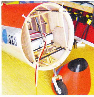
Næsen er afmonteret for montage af pitotrør. En nem operation på et to-motoret fly.
