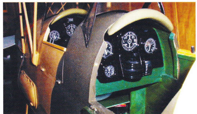
Montering af vindspejl, instrumentbord og stødpudder.
