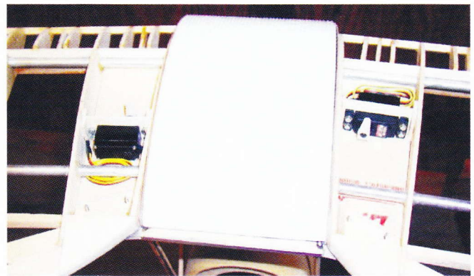
Servoer til slats monteret i øverste vinge.
