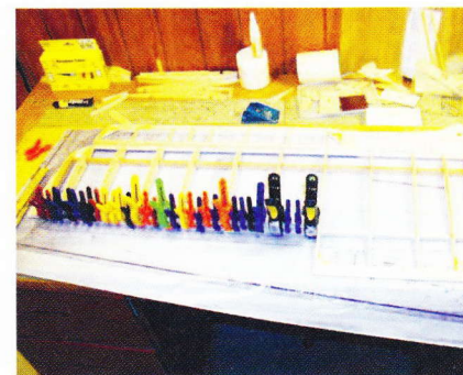
Vingerne bygges på byggepladen.
