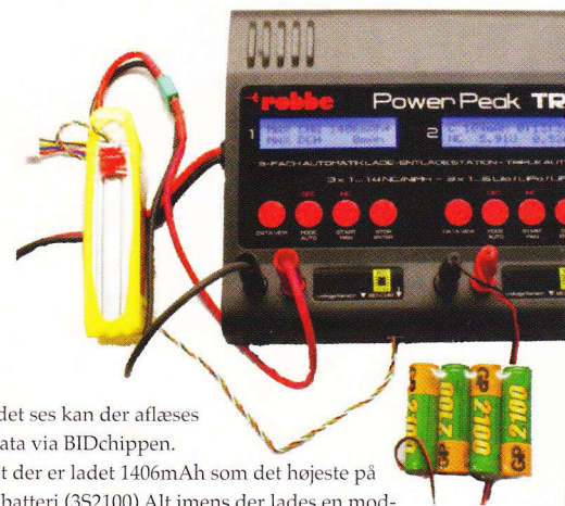
BIDchip monteret på en LiPo-pakke. Kablet er her sat i laderen og der skal blot trykkes på start.
