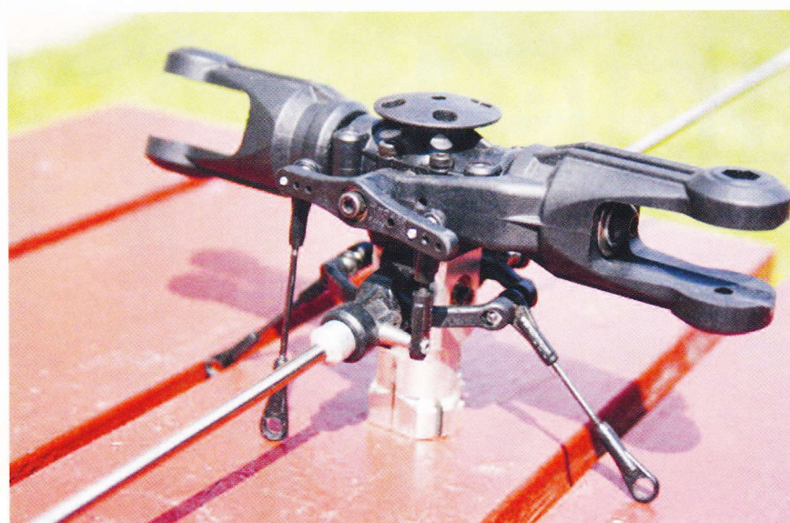
Her kan du tydeligt se indstillingsmulighederne i et Hirobo SDX rotorhoved. Selv om dette er plastik versionen, har det de gode egenskaber man kigger efter når man flyver F3C. Billedet er gengivet med venlig tilladelse fra Hirobo importøren i Danmark.
