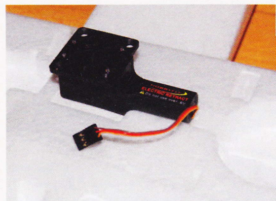
Som det ses er understelsmekanismen lige lidt for stor i forhold til det hul der er i vingen.
