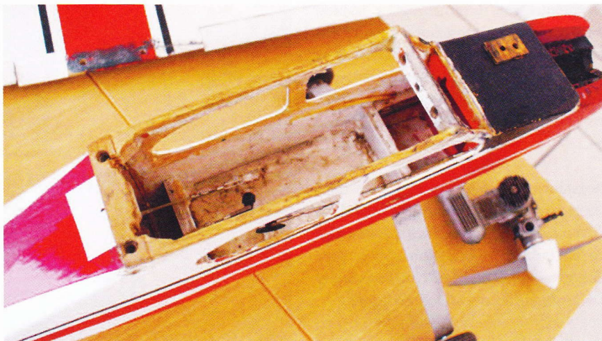
Motor og indmad pillet ud af Charteren. Den er ikke noget kønt syn. Inden kroppen blev "renset" indvendig, blev der fremstillet og monteret et manglende spant.
