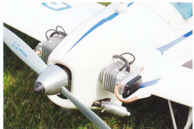
Den fine motordummy bygget af abachifiner, og ikke mindst en masse flid
