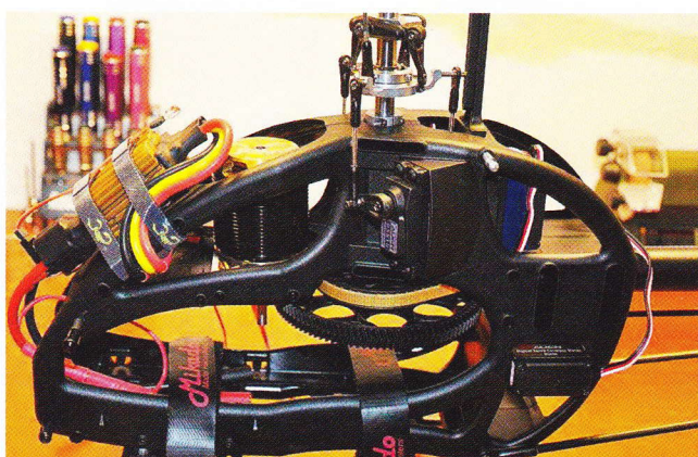
Her ses de monteret. Jeg sat align ds610 servoer på swashpladen. Dem havde jeg liggende, og jeg ved fra mine andre helikoptere, at de virker ganske fint.
