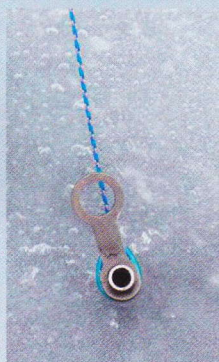
Standard udstyr på isen: Bjergbestignings is-fæstner som skrues ned i isen, De er hule og overskuds isen bliver transporteret op igennem røret.
