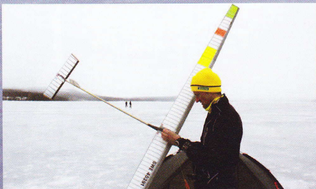
Svenske Robert Hellgren gør klar til start. Robert var meget stærkt flyvende på dagen. Til de ordinære starter benyttede Robert en traditionel M&K model med en spændvidde på 252 cm og til Fly-off brugte han en Flapper.
