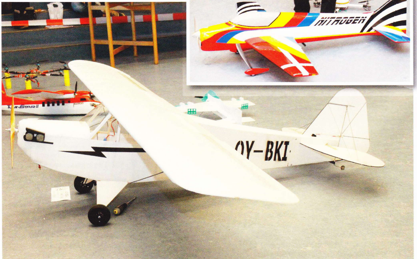
Poul Offersens imponerende Piper Cub bygget i depron, 271cm i vingespænd og en vægt på 2 kg. (ja, TO kg..!!)
