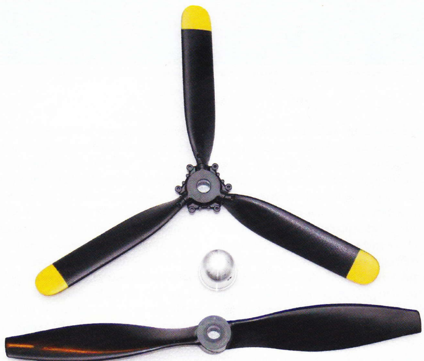
De to medfølgende propeller. Pas på med den trebladede, den er meget blød hvis man tager fat i det ene blad når spinneren skal løsnes/spændes
