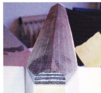
Bagkanten af finnen er opbygget i en hårdere type depron.
