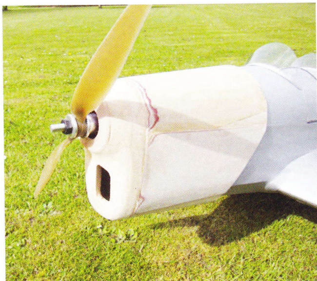
Cowlet er bygget op på den gode gammeldags måde med balsablokke og fine bukkeslet i facon.
