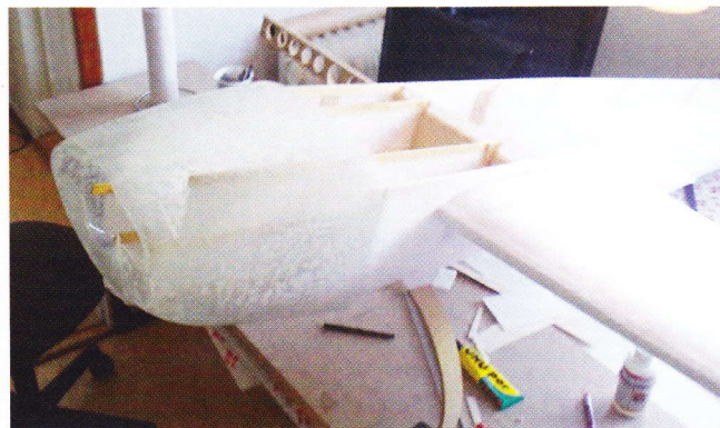
Cowlet som blev støbt uden på cowlet fra Extreme Flight extraens cowl.
