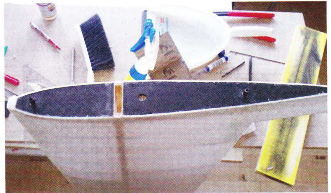
Rodrippen har også fået den hårde type depron. Kulstifterne og gevindet til skruen, som skal holde vingen, ses tydeligt her.
