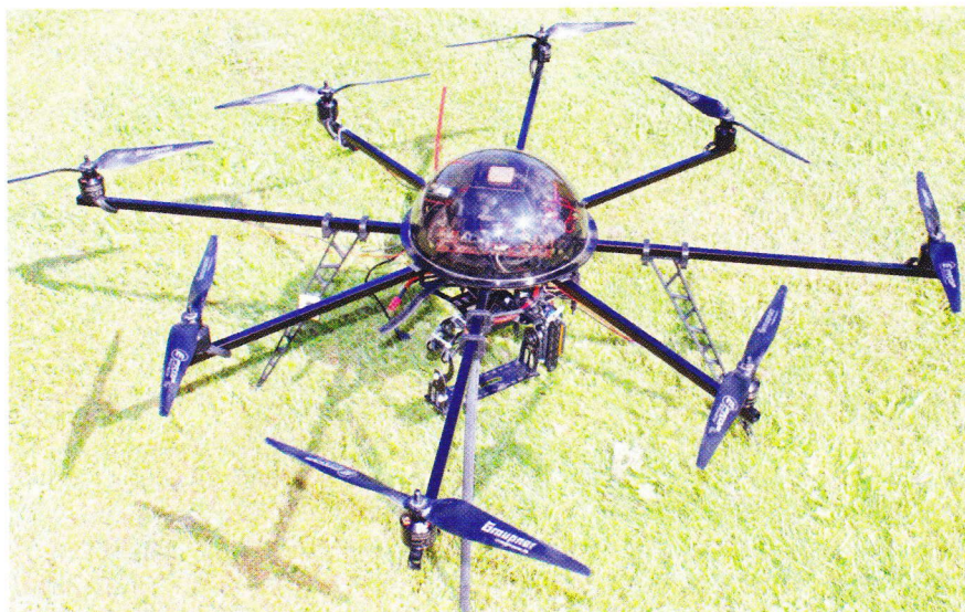
De otte tjekkede og dobbelttjekkede motorer løfter et kamera af så god kvalitet, at også billederne bliver ubegrænsede gode. Specielt når større arealer fotograferes i hundreder af småbidder, som så stykkes sammen til det færdige, højopløselige foto.
