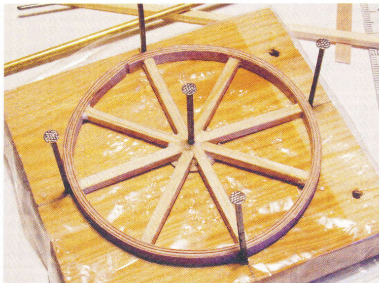
Hjul under bygning. Sommet i midten skal fjernes nu, så det kan løftes af, og den næste fælg placeres, så egerne kan limes i.
