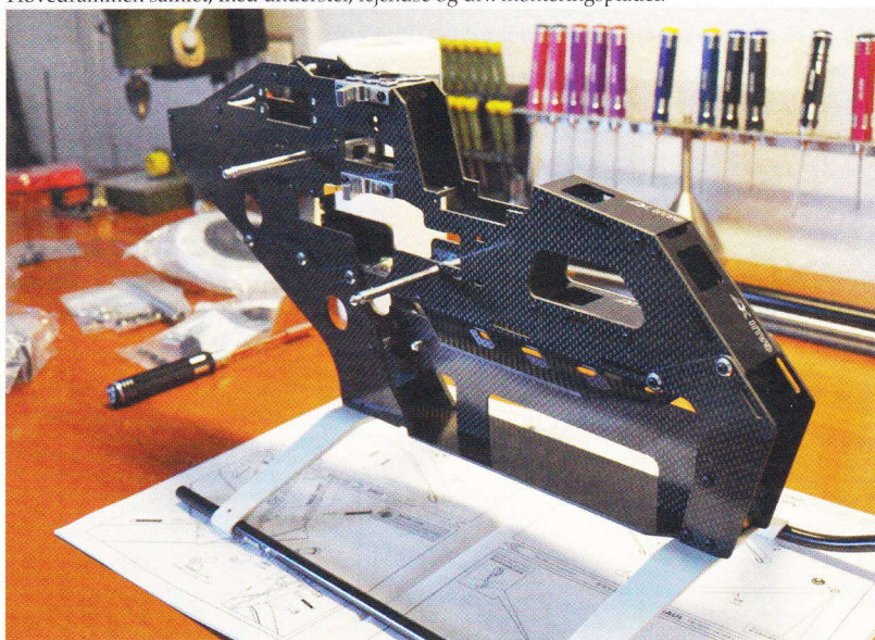
Hovedrammen samlet, med understel, lejhuse og div. monteringsplader.
