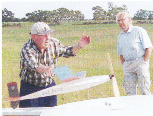
En af mine starter. Sune Starks 51-model er en såkaldt krax-model med to gummimotorer på i alt 120 g, forbundet i serie med et tandhjulssæt i bagkroppen. Betegnelsen krax stammer fra den lyd der kommer fra tandhjulene, når motoren løber ud
