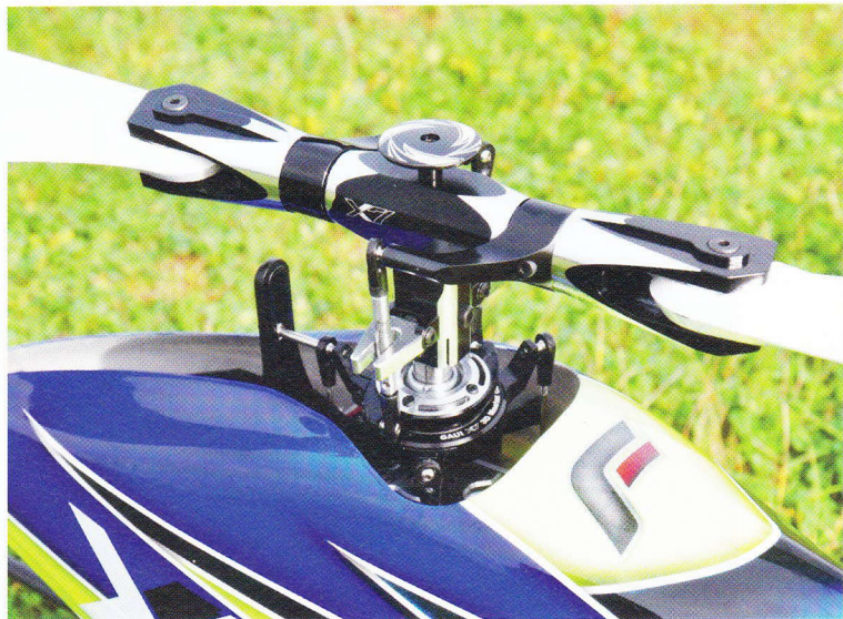
Rotorhoved fremstillet i aluminium.
