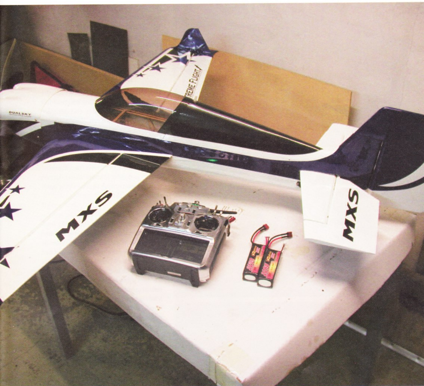
Færdigsamlet og parat på bordet til at få oprettet de tre standard flight-modes som jeg har på flere af mine modeller. 100% udslag og ca 50% og til sidst "så lidt som muligt for ordentlig figurflyvning", typisk er det helt nede omkring 20% af de meget store udslag som alle flyver med.
