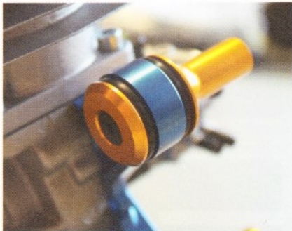
Secrafts floating mount monteret på en DLE 55cc
