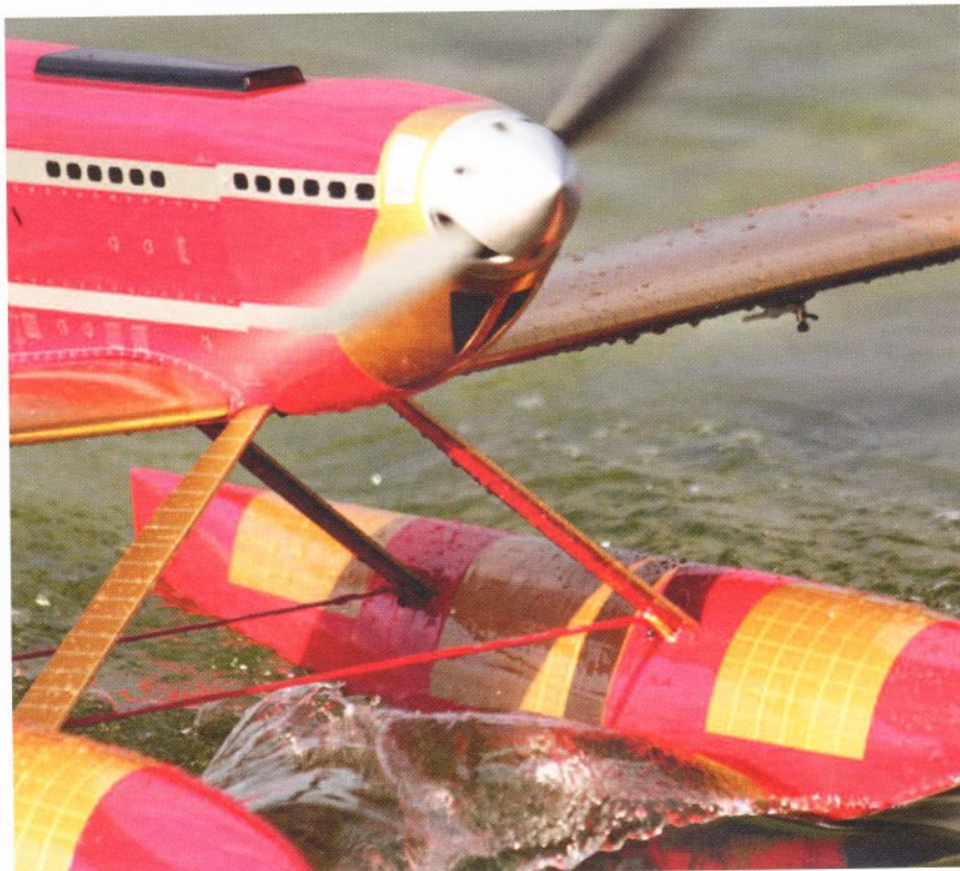
DERFOR skal et vandfly tætnes alle de steder hvor der kan komme den mindste smule vand ind!
