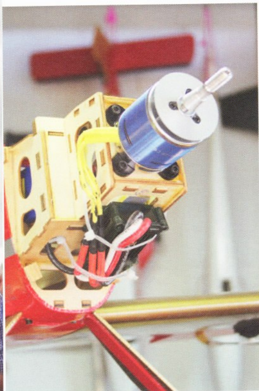
Motor og regulator monteret og fastgjort.
