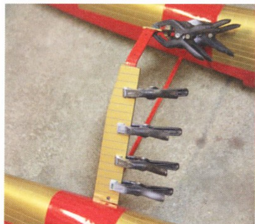
Beklædningen af understellet limes fast med silikone.
