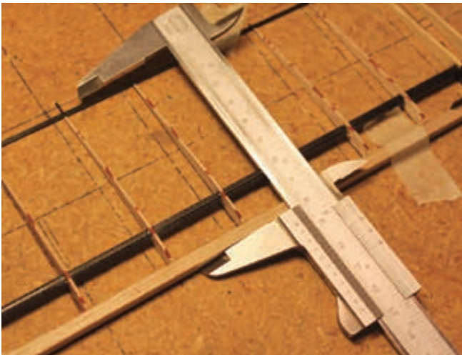
Del 7: Du bestemmer og kontrollerer korden med skydelæren før limning. Jeg kører med 85mm korde.
