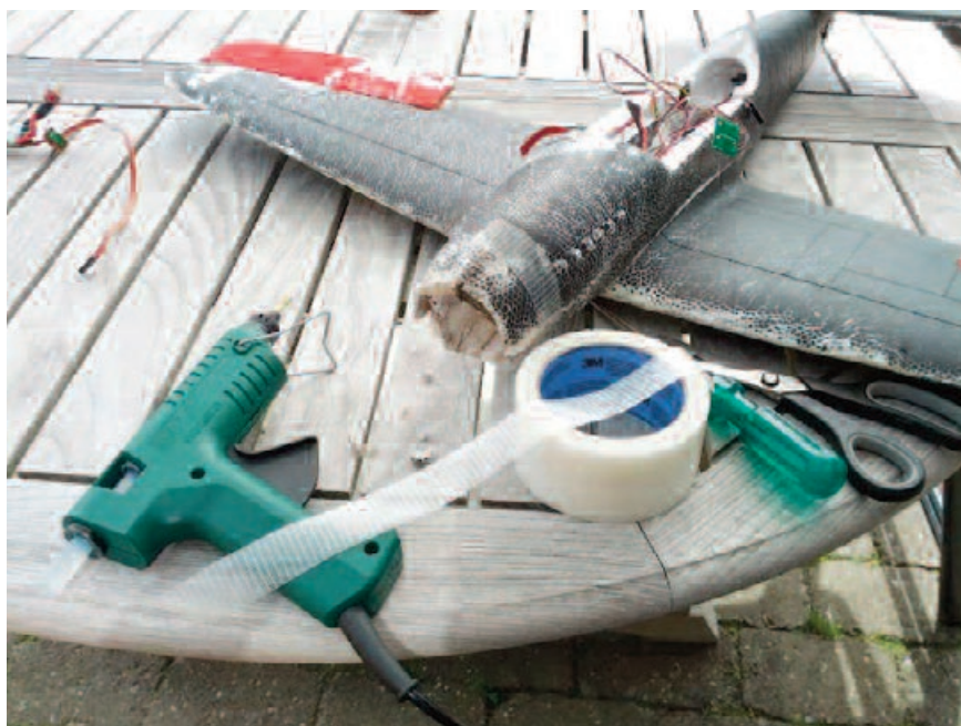
Intet indgyder mere respekt på en kampplads end en arret veteran, her er der gang i feltreparation med tape og limpistol.
