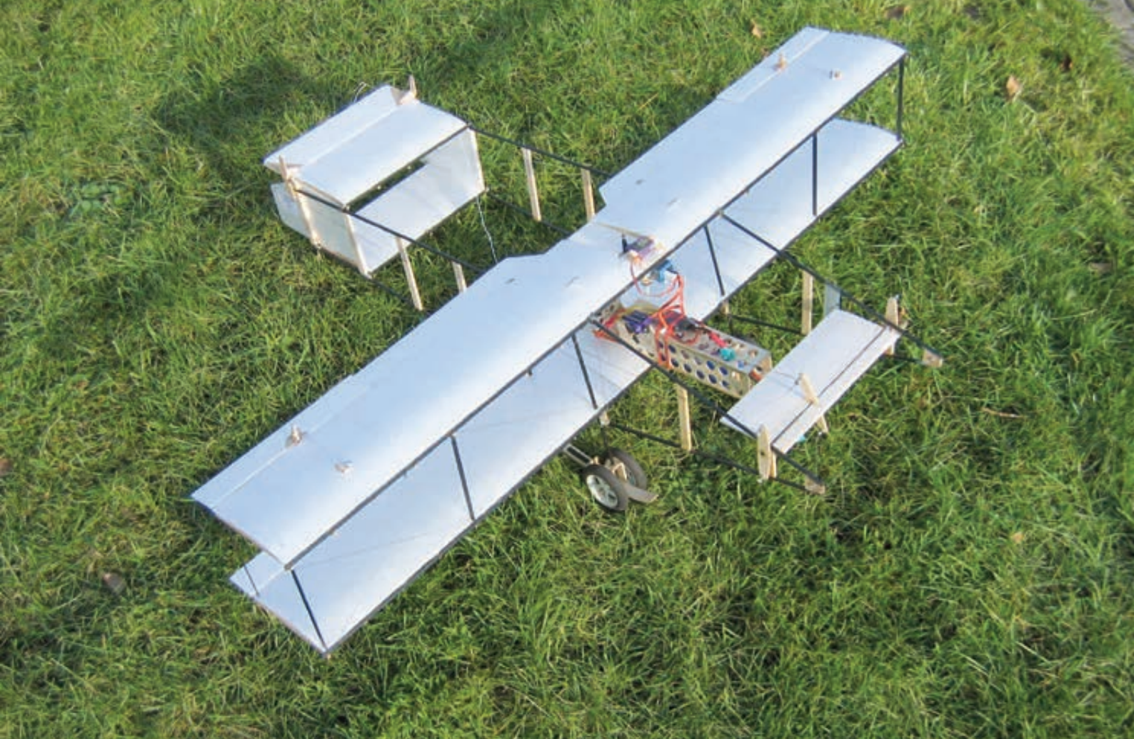
Fly-by-wire-begrebet har ikke noget at gøre med dette fly, hvor alle rorflader er trukket af snore.
