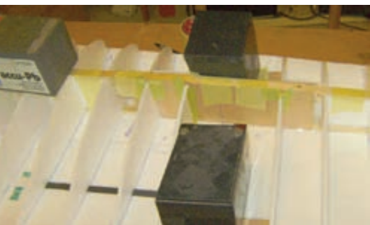
Her bliver kasserne til den ene vingesamling limet ind imellem hovedbjælkerne.
