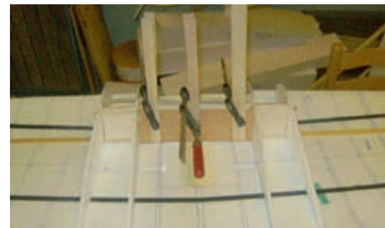
Jeg måtte bygge noget med finer og 10mm balsa, for at lave en stærk midtersektion.
