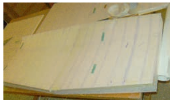
Her ligger der så 3mm Depron i, klar til at få limet hovedbjælker og ribber på plads.
