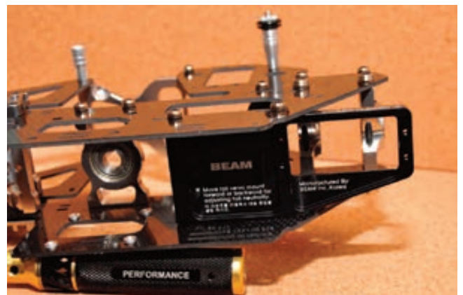
Billede 6 Kuglelinkene skal bare skrues helt i bund, så passer længden perfekt.
