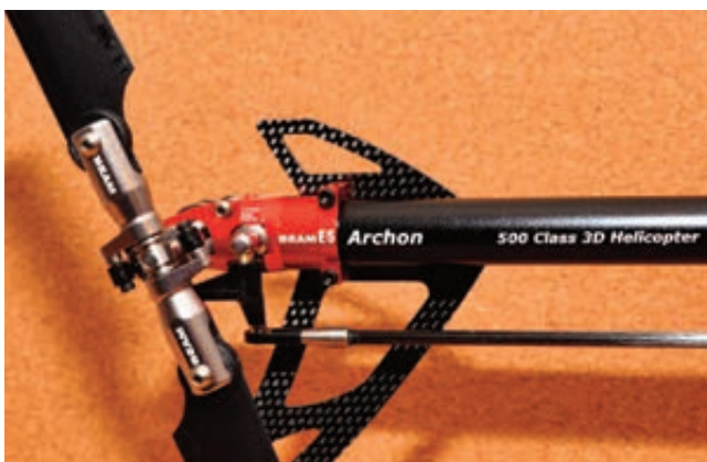
Billede 7 Halerotoren er som hovedrotoren også udført i aluminium
