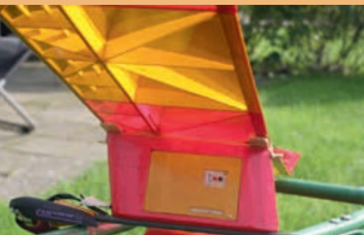
Pylonen, der holder vingen og rummer batteri, timer, servo (til termikbremsen) og ESC
