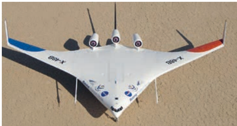
BILLEDE 1: Boeings stormodel har en spændvidde på 6,4m, vejer 226 kg og drives af 3 turbojet motorer. Den anvendes til at undersøge Lift/drag forhold, aerodynamisk stabilitet og kontrol samt støj. Den skal give erfaring til at definere et fortsat udviklingsprogram.
