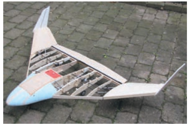
BILLEDE 4. Halvfærdig model som viser opbygningen.
