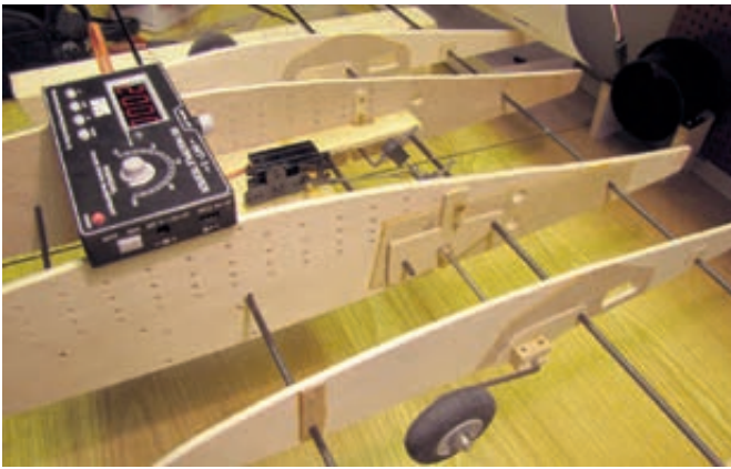
BILLEDE 3. Eksempel på at de kræfter, understellet bliver udsat for, bliver overført og fordelt til kulrøret og rippen. Man ser desværre på mange færdigfremstillede modeller, at understellet bliver revet af under landinger. Pianostråden virker udefra hjulet og ind til midten af kroppen som torsionsstang. Den er her bukket op i 90grader og går imod en 5mm kulstang som stop. Dette forhindrer, at kræfterne overføres til servoen. Konstruktionen er kun mulig, fordi hjulene svinges fremad og op i kroppen. Det samme gælder næsehjulet som trækkes af en kulstang.
