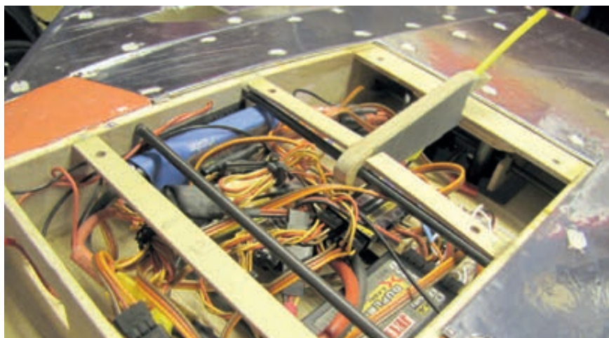
BILLEDE 5. Underste lastrum er fyldt med elektronik, noget af en rodebutik. Desværre udgør ledningerne en unødvendig mervægt, men da jeg bruger telemetrimodulerne i andre modeller, har jeg ikke lyst til at forkorte dem. Bemærk den ene 2,4GHz antenne i det gule plastrør.
