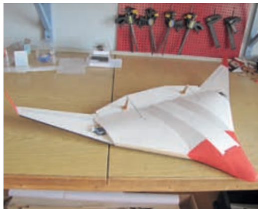
BILLEDE 2: Den lille testmodel, som blev anvendt til forundersøgelser af: tyngdepunktets placering. (Se LINK 2), stabilitet over de tre akser, manøvrerygtighed, samt måling af flyvefart og glidetetal.
