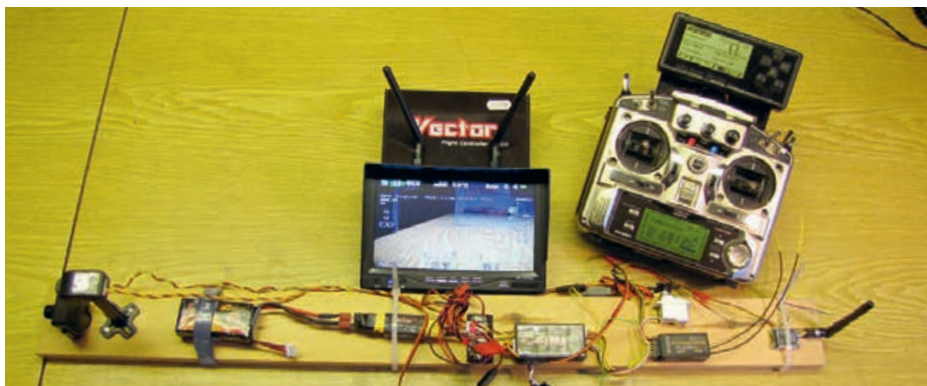
Billede 1. Fra venstre mod højre ses: Video kamera, GPS, Li-Po batteri, PSU med MUI, 5V PSU, Controlleren, 6 kanal Jeti RC modtager og en 5,8Ghz Video sender.
