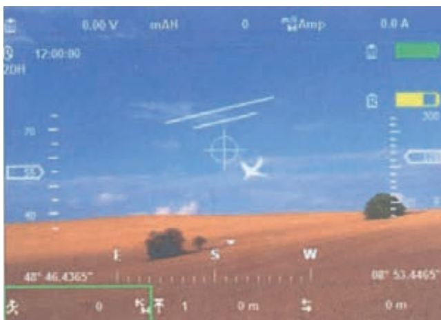
Fig. 3 Video skærm med telemetri data. Data lægges oven i billedet såkaldt On Screen Display. Man kan blandt andet aflæse batterispændingen på flybatteriet, det vigtige milliamperetimerforbrug og strømforbruget. Der findes en airspeedmåler og en højdemåler samt afstand fra homepoint. Derudover haves et kompas, GPS koordinater samt en kunstig horisont.
