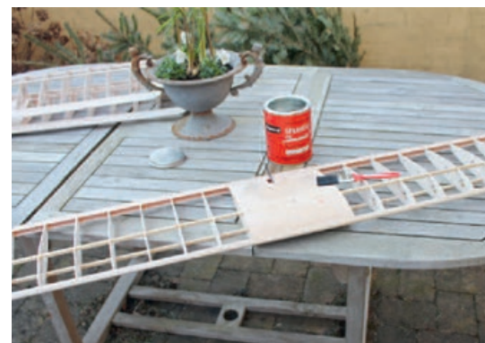
Vingen, som skal beklædes, dopes tre gange med lette mellemslibninger.
