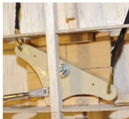
Montagen skal tåle et træk på 10 x modellens vægt!
