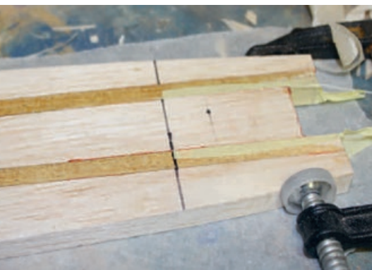
De to hårdtræs kæber limes på plads med epoxy
