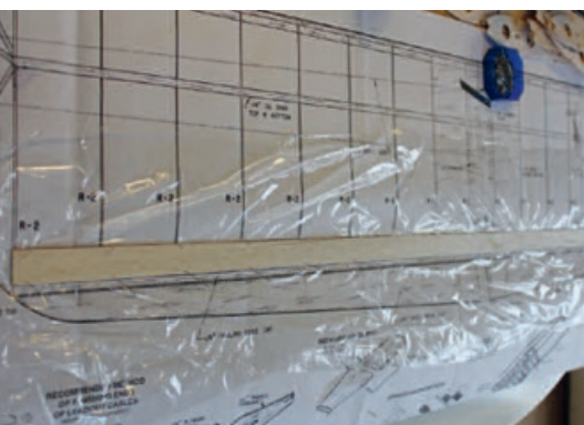
Undersiden af bagkantlisten sat fast på tegningen.
