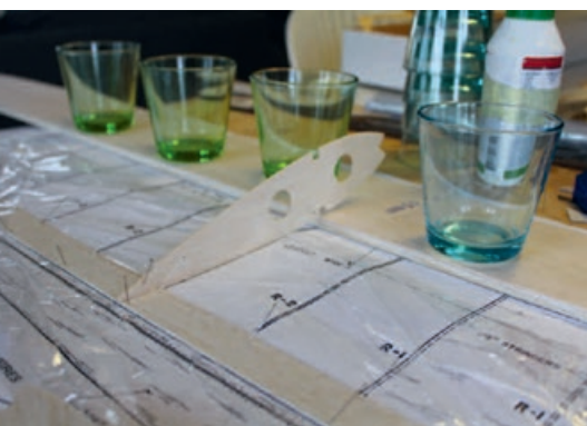
Ribber på med lim på bagkanten og nåle for og bag.
