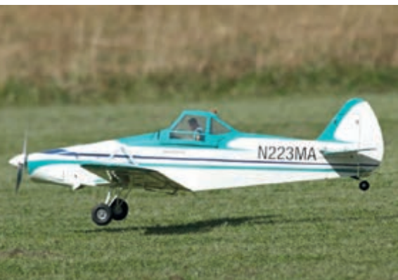
Piper Pawnee fra Hangar 9 med EL-opsætning OS-motor og regulator og 6S 6200 mA. Sp. 204 cm. Ejer Henrik Malmvig.
