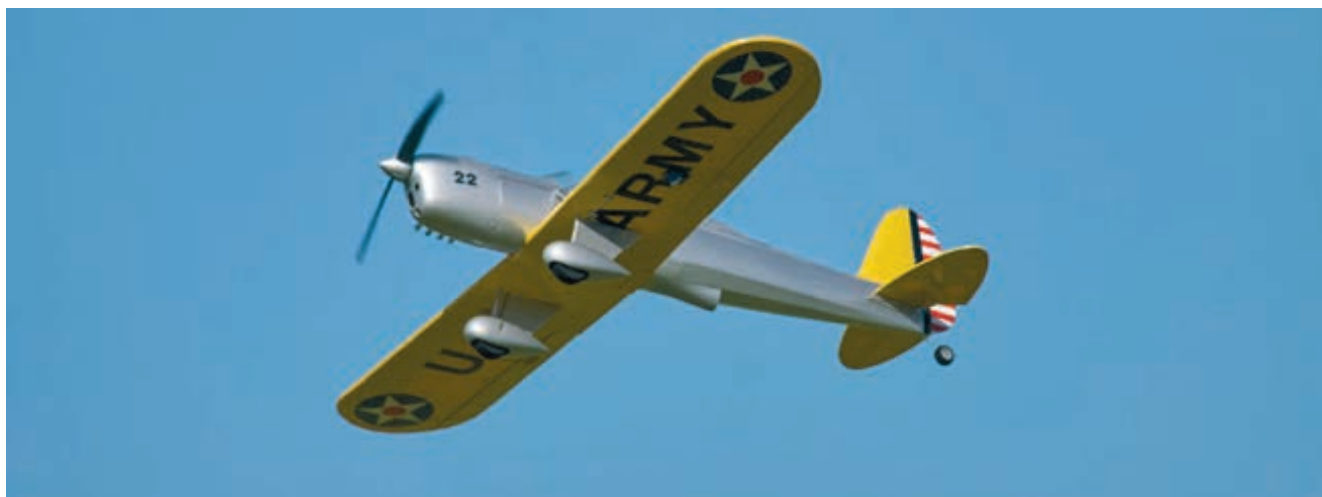
Ryan STA fra Dura-fly Balsa Series, sp. 96,5 cm, længde 82,5 cm, skala 1:9,5 vægt 925 gram, motor NTM3530 m. 25A regulator 3S-2200 mAh. Ejer Peter Weichel.
