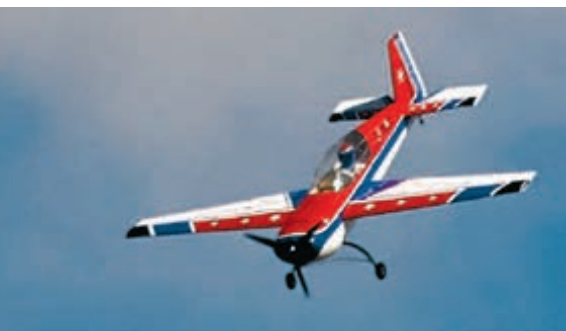
Extra 300 fra Extremeflight 317,5 cm skala forhold 40% vægt 19,4 kg motor ZDZ 180b2 rv-j champion 20 HK propel 21x12" trebladet Müller prop. Brandstof Shell WPover 99 m. 2,5% billigste Har- rald Nyborg olie. Ejer Flemming Bollerslev.
