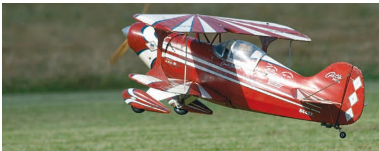
Pitts Special S-1S skala 1:3, bygget 1980, sp. 176 cm, vægt 10 kg, motor GR-Pro 2-takt Boxer (Kina) benzin m. 2,5% olie 5200 RPM m. 20x10" træpropel (PoM) statisk træk 7,1 kp. Effekt 4,7 HK Krop: styoporskum m. glasfiber, Cowl glasfiber/epoxy. Vinge: styopor m. glasfiber/epoxy beklædning ilagt fyrretræs hovedbjælker. Ejer Poul Münsberg.
