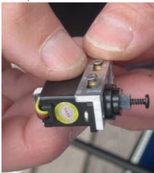
Servomount med mulighed for justering til haleplanet. Igen en enkel og god løsning.
