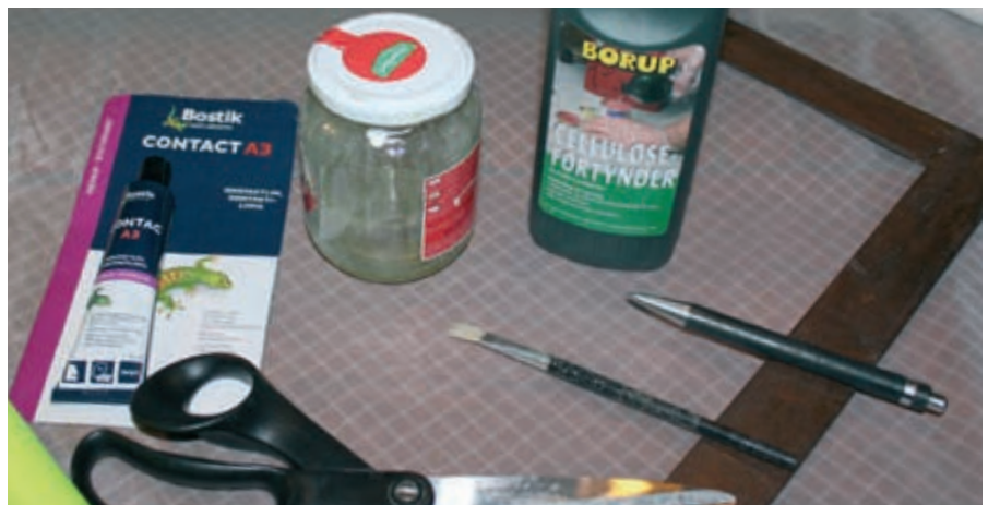
De vigtigste ting til beklædningen: Vinkel lineal, En god saks (jeg bruger Fiskars), kuglepen, Pensel, Cellulosefortynder, Bostiks kontaktlim og en bøtte hvor kontaktlim og cellulosefortynder kan blandes. Det ses at der er tydelige kvadratiske forstærkningstråde i Icarex klædet.
