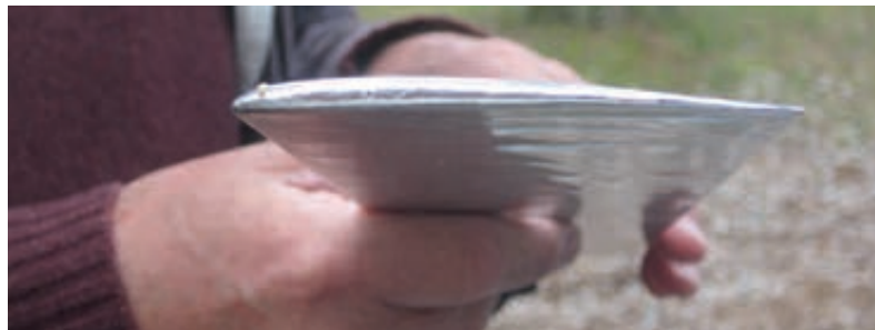
Halplansprofilen er ikke så specielt, men bemærk der bruges turbulator.
