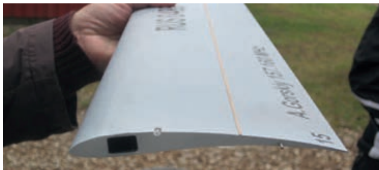
LDA vingen Anton bruger er produceret i hel-kulfiber, med kulfiber wing-joiner. Løsningen er efterhånden også brugt af flere danske F1A piloter.
