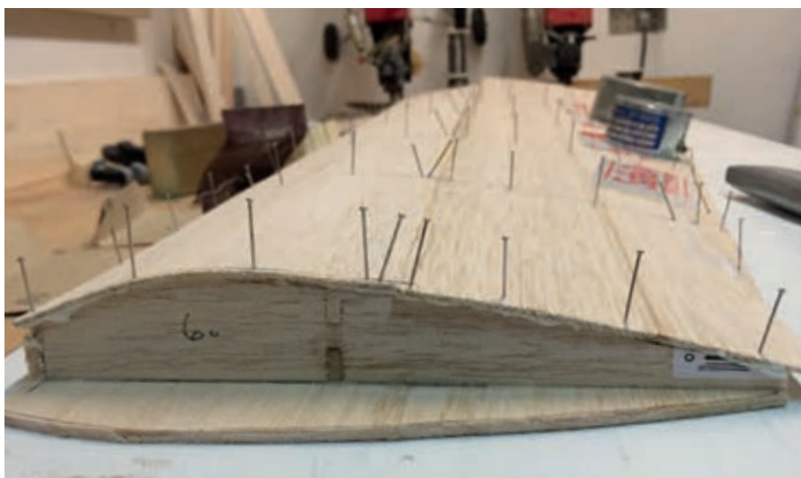
Godt med nål i det tynde balsa-lag der udgør vingens overside.
