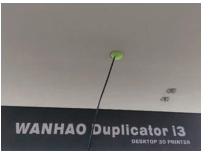
Støvfiltret lavet af en skuresvamp for at forhindre at støv bliver trukket med ned i ekstruderen
