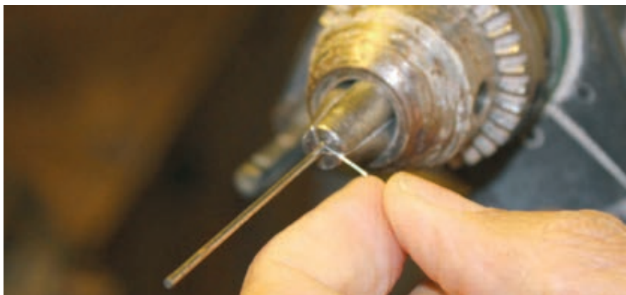
Så skal pianotråden sættes i slidsen til borekernen.
