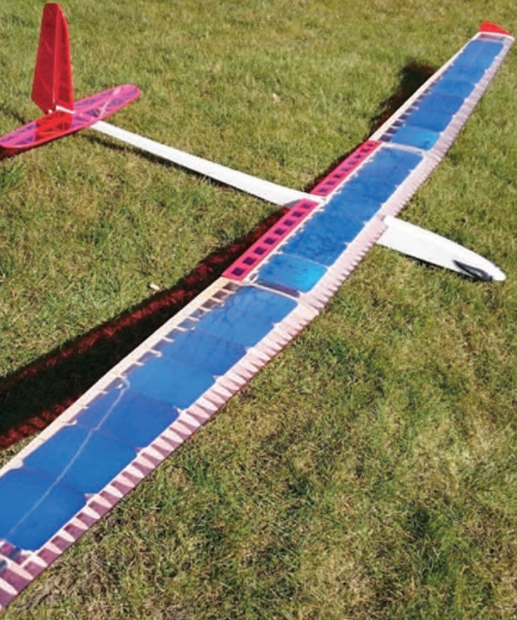
Solcellerne smelter sig selv fast til filmen når de bliver varme. De to flaps bruges som krængører og bremses.
