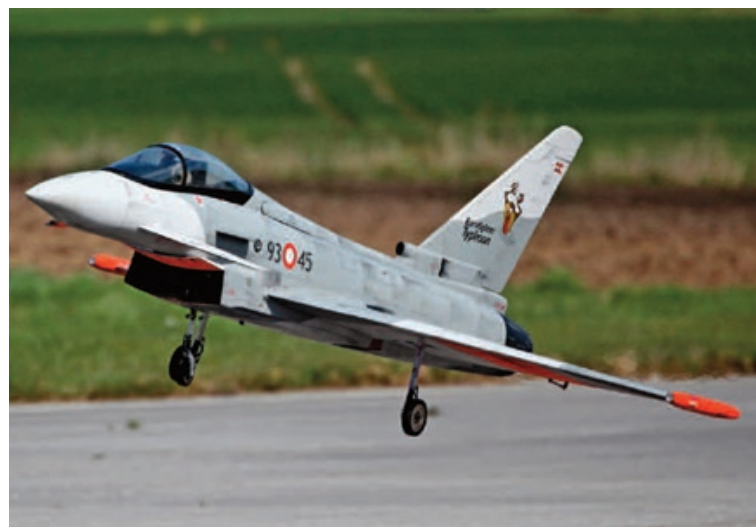
EUROSPORT. Pilot: Henrik Jørgensen. Radio: Futaba 18 ZG. Klub AMC. Sted: Haderslev Flyveplads. Skala 1:6,4. Spændvidde 170cm. Længde 230cm. Vægt: 16 kg. Motor: Jetcat P-180. Tryk 18 kg. Tophastighed 330 km/t.
