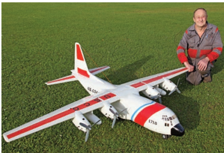
C130 HERKULES. Pilot: Jan Linnebjerg. Radio: Multiplex 4000. Klub: Bording airport. Skala 1:16. Spændvidde 250 cm. Længde 190 cm. Vægt ca. 8 kg. Motor 4 stk. OS 60 FSR. Samlet 6,4 Hk. Propel: 11"x7" 3 bladet. Tophastighed ca. 140 km/t.
