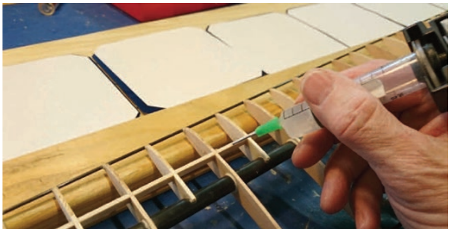
Silikone blev påført med lufttryk i punkter inden cellerne blev monteret. I sin originaludformning har tippen et knæk, som jeg fjernede for at få plads til 7 celler.
