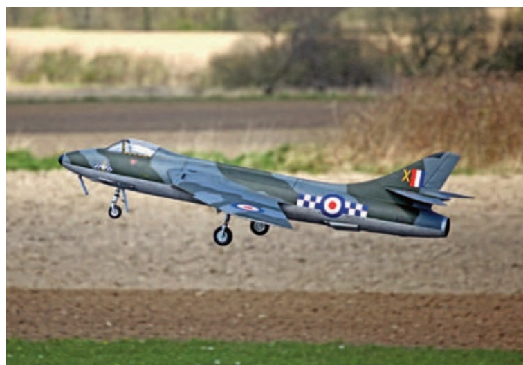
HAWKER HUNTER. Pilot: Kim Frandsen. Radio: Futaba T14S4. Haderslev Mfk. Skala 1:6. Spændvidde 173 cm. Længde 236 cm. Vægt 17,5 kg. Motor JETCAT P160. Tryk 16,3 kg. Tophastighed 290 km/t.
