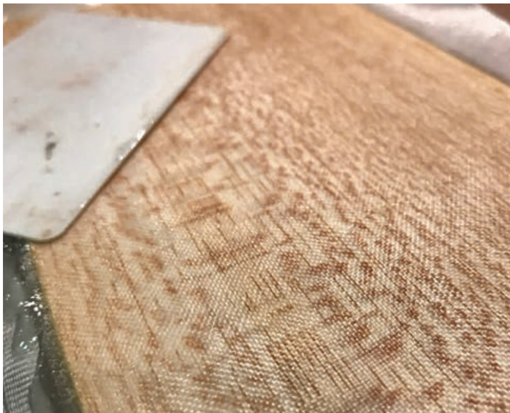
Overskydende epoxy skrabet af med "kreditkort". Efter hærdning gentages processen indtil vævet slet ikke kan ses
