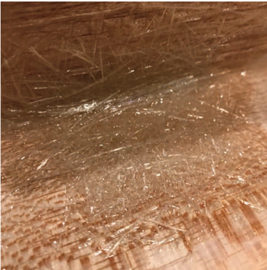
Nu er det helt gennemvædet af epoxy – og er STÆRKT når epoxyen er hærdet.
