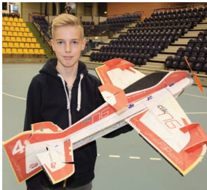
Clik NG. Pilot Max Kjær Munk. Radio Spektrum DX7S. Klub Silkeborg El&Svæv. Sted: Jysk Arena Silkeborg. Spændvidde: 84 cm. Længde: 96 cm. Vægt: 124 gram. Motor: Tiger Motor: 60 Watt. Batteri: 2s 300mA. Propel 8"x4"
