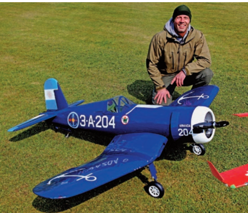
F4U Corsair. Pilot: Dan Kristensen. Radio: Spektrum 2,4. Klub: Pandrup. Sted: Area 15. Skala: 1/5. Spændvidde: 220 cm. Længde: 176 cm. Vægt: ca.14 kg. Motor: Saito FG 90 3 cyl. Static thrust 9 kilo. Battei: Lipo 2s 2900 mA. Propel: 24"x10".
