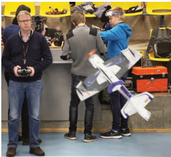
Clik R2. Pilot: Mikael Lundqvist. Radio: Spektum DX9. Klub: Silkeborg El&Svæv. Sted: Jysk Arena Silkeborg. Spændvidde: 83 cm. Længde: 93,5 cm. Vægt: 160 g. Motor: Tiger motor 2202 outrunner. Watt: 60. Batteri: 2s/350mA. Propel 7"x 3,5"
