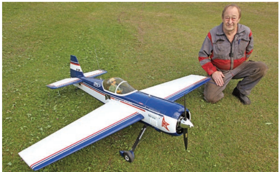
Classic Flash. Pilot: Lars Robert Nielsen. Radio: Futaba 18SZ. Klub: Østjysk r/c MFK. Sted: Stauning. Spændvidde: 162 cm. Længde: 207 cm. Vægt: 11 kg. Motor: Jetcat P100. Tryk: 10kg. Tophastighed: ca. 330 km/t.
