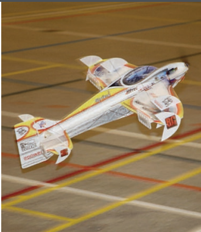
Spies. Pilot: Claus Engfred Olsen. Radio: Jeti DC 16. Klub Ormslev. Sted: Balle skole hallen Silkeborg. Spændvidde: 80 cm. Længde 100 cm. Motor: Hyperion outrunner Z 1705-11. Batteri: 2s 300mA. Propel 8"x4".
