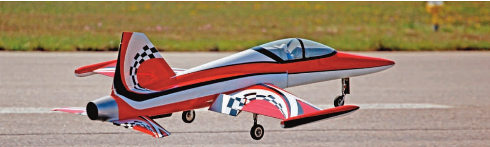
Classic Flash. Pilot: Lars Robert Nielsen. Radio: Futaba 18SZ. Klub: Østjysk r/c MFK. Sted: Stauning. Spændvidde: 162 cm. Længde: 207 cm. Vægt: 11 kg. Motor: Jetcat P100. Tryk: 10kg. Tophastighed: ca. 330 km/t.
