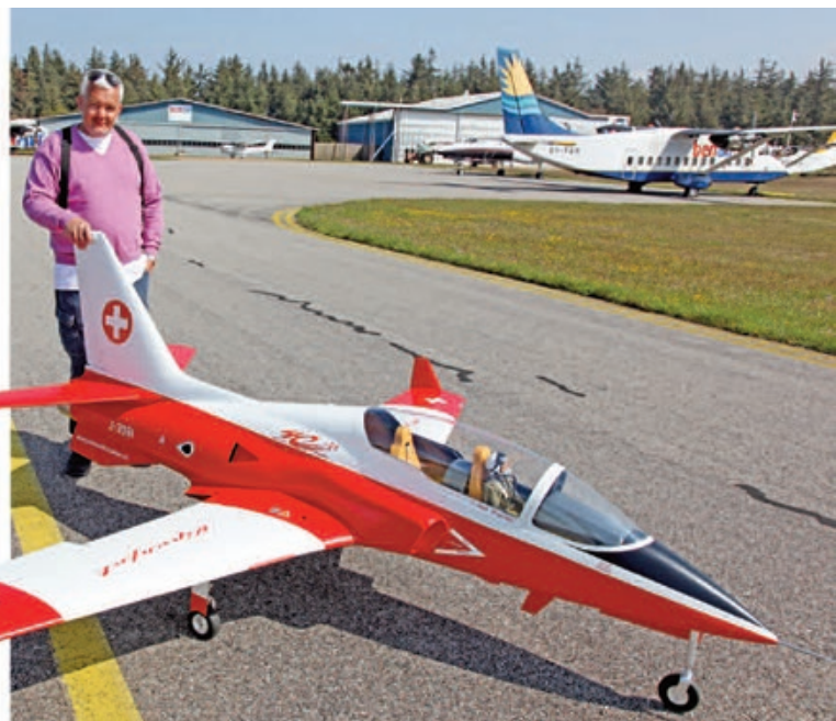
Viber Tomahawk XXL. Pilot: Nicolai Kaaber. Radio: Futaba 18MZ. Klub: Jet Danmark. Sted: Stauning. Skala: 1:3,3. Spændvidde: 348 cm. Længde: 293 cm. Vægt: 24,8 kg. Motor: Frank 27 kg .
