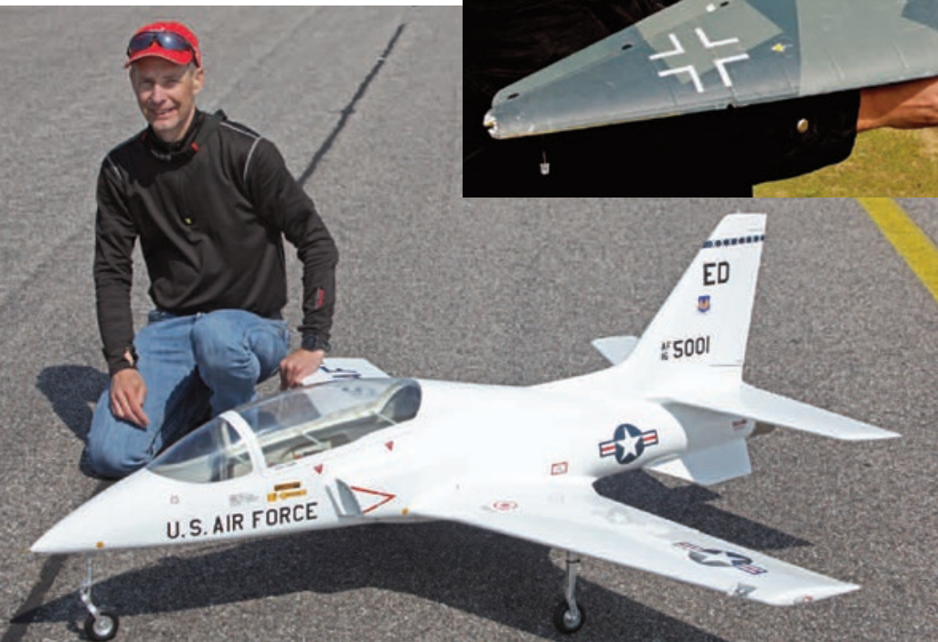
Viber Jet. Pilot: Jens Aabo. Radio: Jeti DS. Klub: KFK. Sted: Stauning. Spændvidde: 200 cm. Længde: 200 cm. Vægt: ca. 12kg. Motor: Jetcat P90 RXI-B. Tryk: 10 kg. Tophastighed: ca. 300 km/t.
