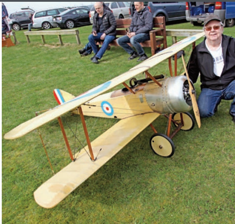
Sopwith Pup WW1. Pilot: Flemming Vestrup. Radio: Multiplex. Klub: Midtjysk Mfk. Sted: Herning. Skala: 1:3,3. Spændvidde: 246,5 cm. Længde: 190 cm. Vægt: ca. 15 kg. Motor: 5 cyl. Radial 65 ccm. Propel: 24"x10".
