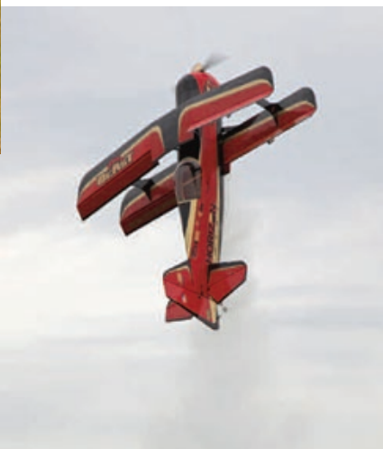
The Beast. Pilot: Michael Vermund. Radio: Futaba. Klub: KFK. Sted: Brande Stormodel Træf. Spændvidde: 226 cm. Længde: 225 cm. Vægt: ca. 14 kg. Motor: DA 100 ccm. 10 hk. Batteri: 2s 2500mA lipo. Propel: 28"x10".
