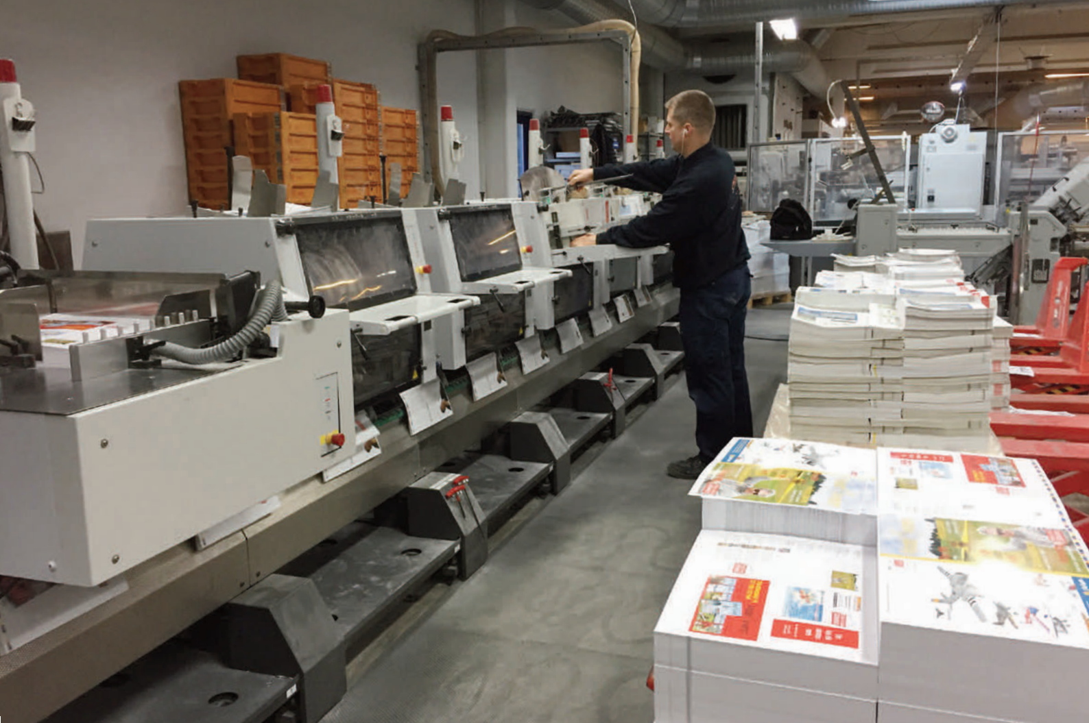
På trykkeriet er det kæmpemaskiner, der tager sig af trykning, foldning, hæftning og beskæring af Modelflyvenyt
