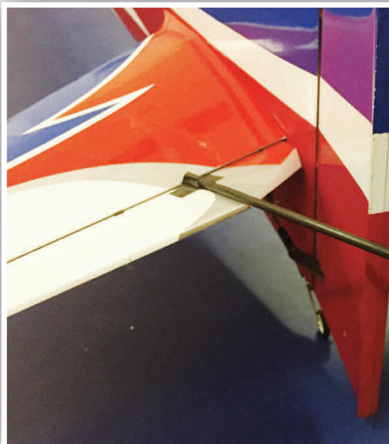
Tape to pinde på rør, og juster endpoints indtil udslag er ens på dem begge.
