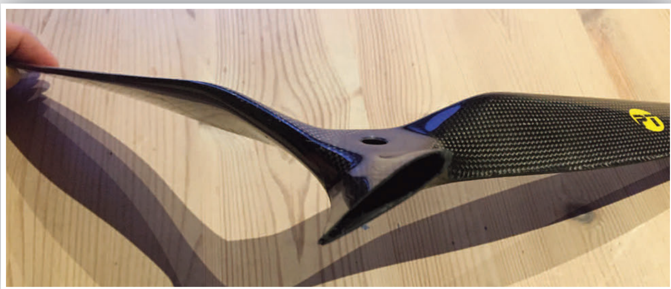
Superfin opskåret kulfiberpropel, der ikke kunne klare mødet med en frossen bane. Der er ikke meget til at give styrke indvendigt.
