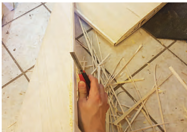
Her er jeg ved og skære alle listerne til på alle vingene, og at skære ud til hvor servoerne skal sidde.
