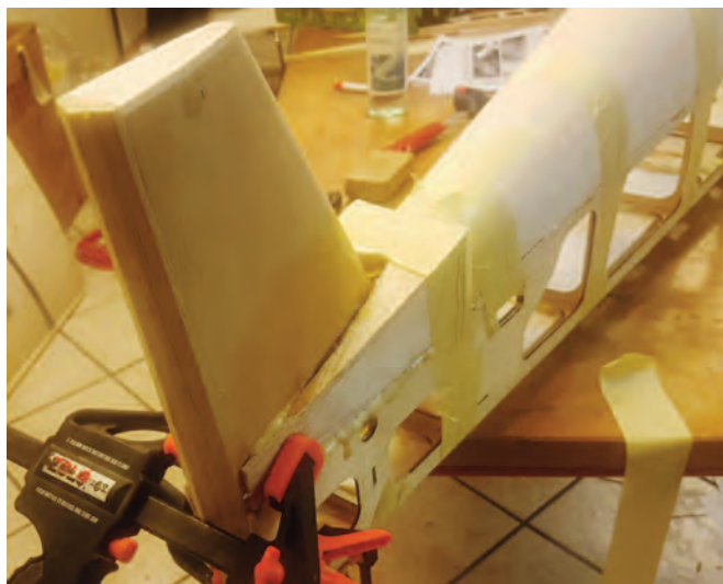
Her er jeg i gået i gang med at bygge halen. Det hele skal skæres og slibes til bagefter når limen er tør. Det er et stort arbejde. Det tager mange timer, da alt i byggesætte kun delvist er gjort klar.
