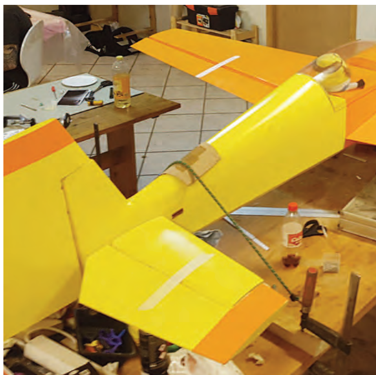
Så er jeg gået i gang med at beklæde den. Jeg valgte og bruge Solartex folie, som er en slags væv. Det skulle være super godt til store Modeller. Og det kan lakeres oven på.
