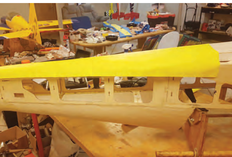
Så er jeg gået i gang med at beklæde den. Jeg valgte og bruge Solartex folie, som er en slags væv. Det skulle være super godt til store Modeller. Og det kan lakeres oven på.
