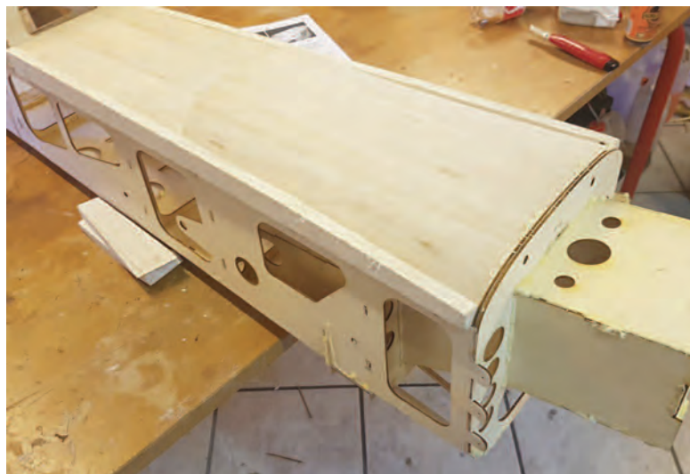
Så jeg i gang med canopyet. Her skulle jeg lime to store plader sammen, lime lister på osv. Det hele er firkantet og jeg skulle selv pudse det hele flot og rundt med sandpapir og håndkraft.
