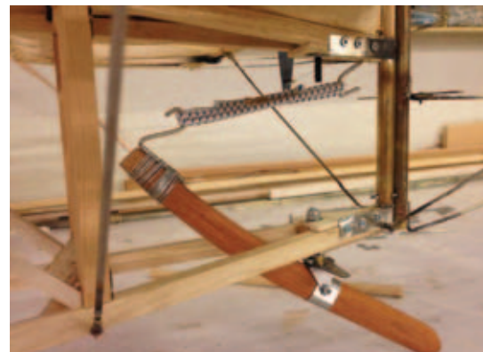
Man brugte ikke hjul til haleplanet men en "pind" med en fjederløsning
