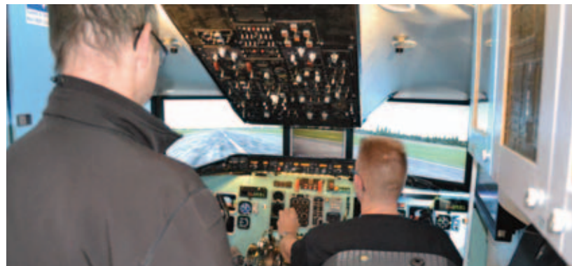
Under hele stævnet, var der også besøg af Claus Nørgaard, som har bygget en komplet flysimulator i en campingvogn. Det er et cockpit fra et MD-80 rutefly, som man kunne komme ind og prøve. Det er virkelig imponerende og han har bygget det hele selv af diverse computerdele og flyindmad. Læs mere på hans hjemmeside: https://sites.google.com/site/danskemd80cockpitprojekt/
