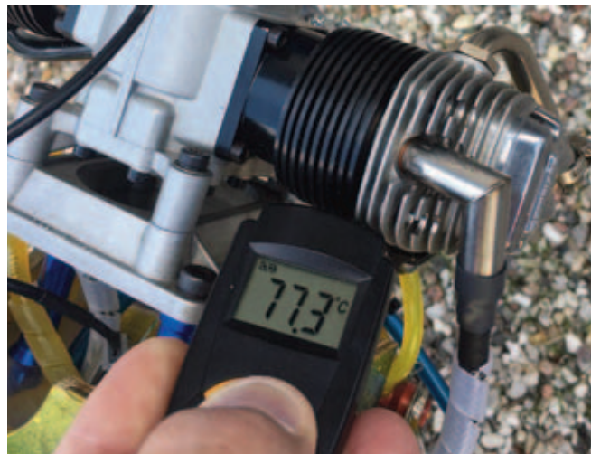
Med et infrarødt termometer kan cylindertemperaturen tjekkes. Den var markant lavere end jeg havde forestillet mig.
