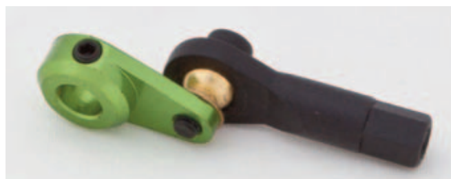
Den CNC fræsedede gasspjældarm og kugle linket er en lækker detalje.
