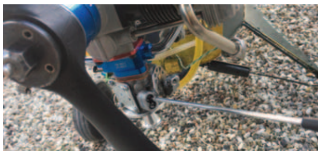
De to blandingskruer (LO og HI) er hed ved at blive justeret. Det kræver at motorens stoppes for at man kan komme til nålene, men det fungerer godt når man har en opto-kontakt ind over den funktion.
