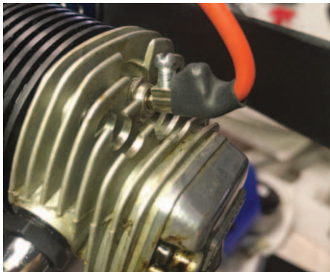
Gløderør fjernes og de gamle ledninger til evt. glødeautomatik fjernes. De kan ikke genbruges her.
