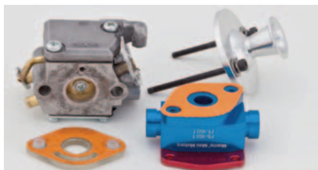
Karburator, termopakning, manifold og indsugningsstak. Pasningerne er fine og de anodiserede overflader ser godt ud.
