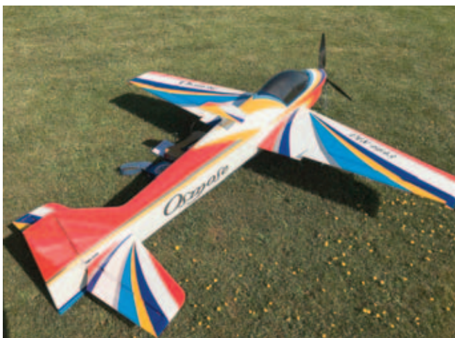
Trebladet propel for bedre bremseeffekt
