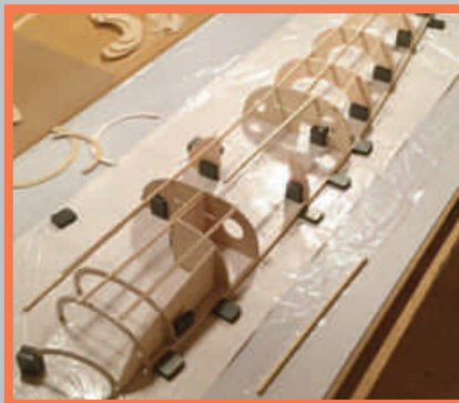
Opbygning af den ene halvdel af kroppen.
