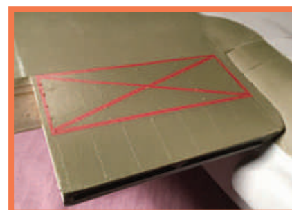
Kølerindtag: Detalje fra vingen, hvor køleren sidder.
