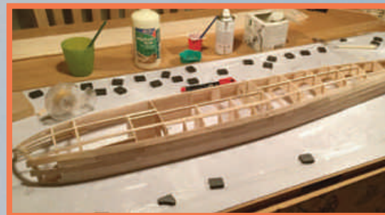
Den ene halvdel af kroppen i gang med at blive beklædt med balsa-planker.
