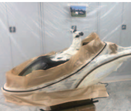
Der er dækket af til flydende guld, som skal påføres i ca. 10-15 lag
