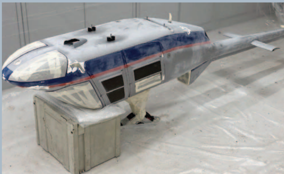
Mærker fjernet, og model slebet ned så den fremstår glat
